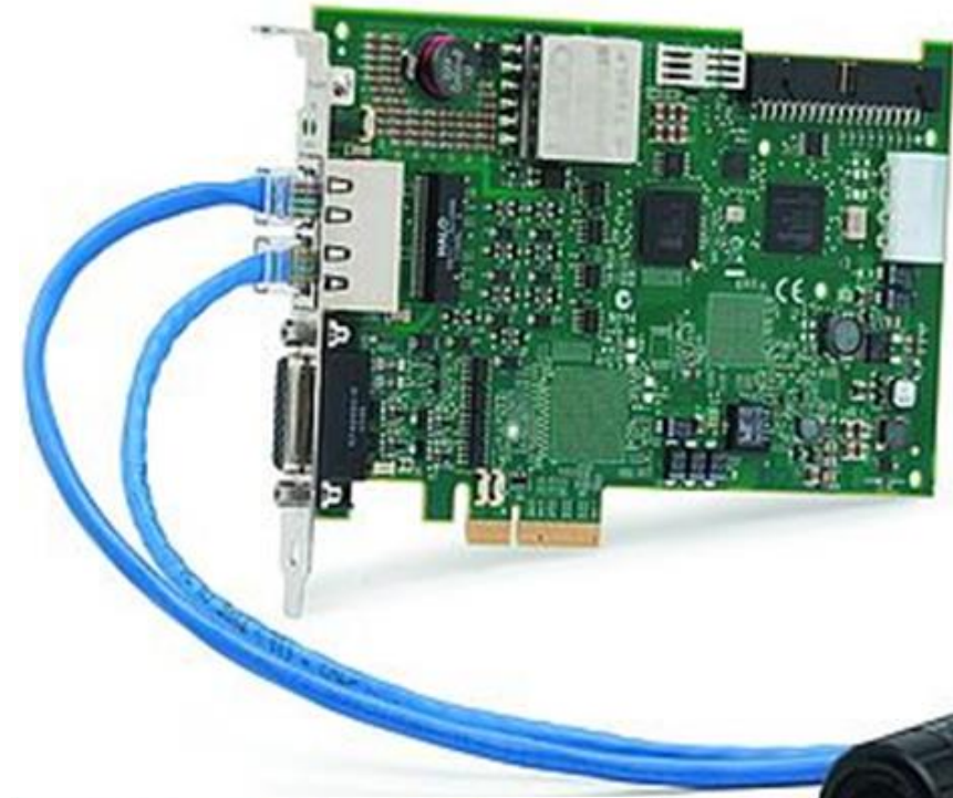
Carte d'acquisition spécialisée dans la numérisation d'images
